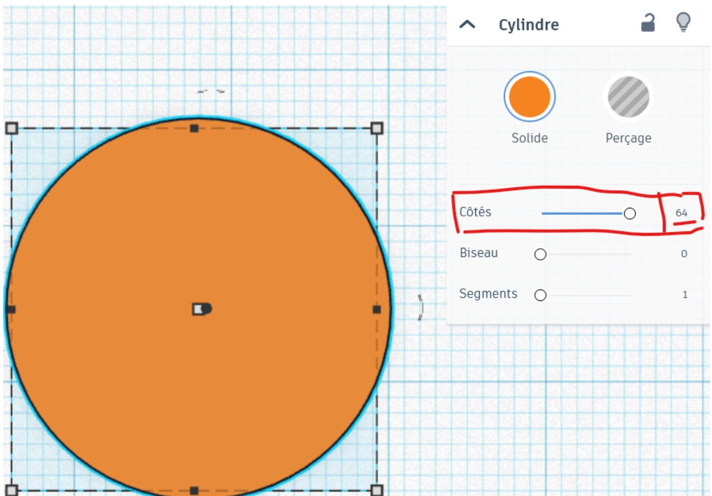
Ainsi, pour réaliser une pièce de révolution à partir d'un dessin 2D, il suffit de le faire suffisamment fin et de le copier 64 fois en le faisant tourner de  $180^\circ/64$ . Exemple :
