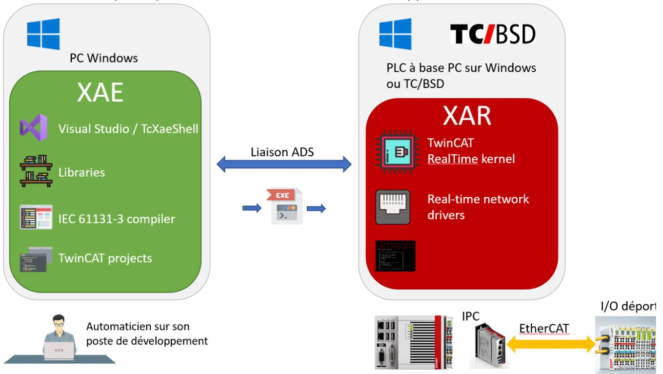
Sur le poste de développement, on va générer un exécutable qui sera transféré sur le Runtime. L'exécutable + le Runtime vont transformer la base IPC Windows en Soft PLC avec d'excellentes performances temps réel.
