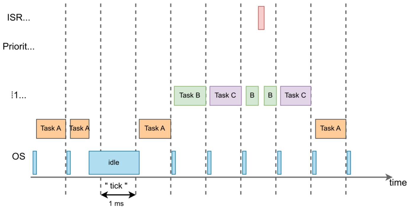
Les ISR sont des sections de code exécutées par le micro-contrôleur et non par FreeRTOS. Ce qui amène à des comportements inattendus du noyau. Pour cette raison, il est nécessaire de réduire au maximum le temps d'exécution d'une ISR. FreeRTOS fournit des méthodes servant à la gestion des interruptions et peut également lancer des interruptions par appel à une instruction matérielle.
