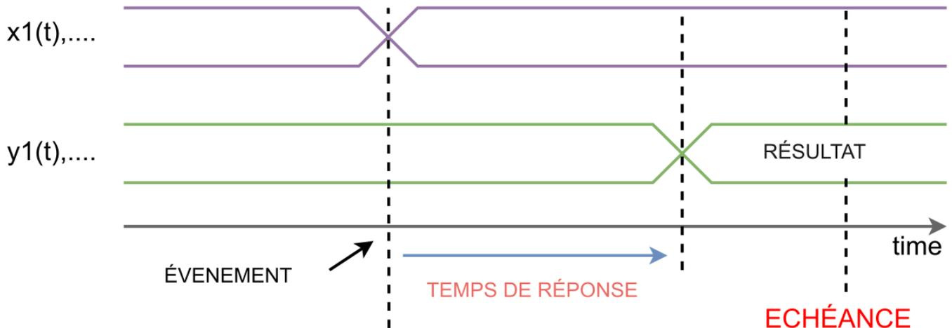
L'échéance (deadline) fixe le délai maximal alloué au système temps-réel pour obtenir le résultat après un événement.
