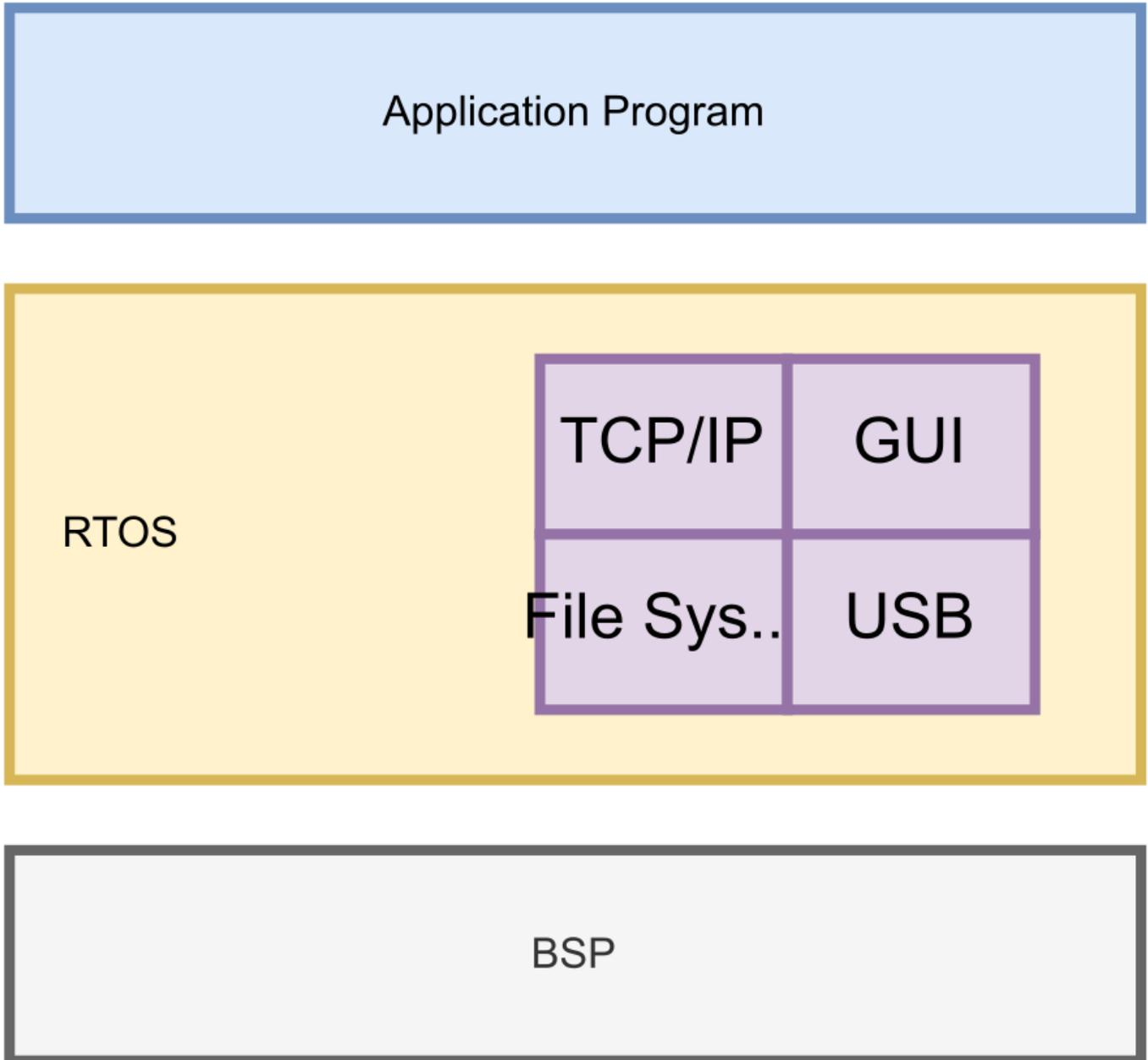
Dans les systèmes embarqués, une couche supplémentaire peut exister, le board support package(BSP) contient le micrologiciel de démarrage spécifique au matériel, les pilotes de périphérique et d'autres routines qui permettent à un système d'exploitation embarqué donné, de fonctionner dans un environnement matériel donné (carte mère):
