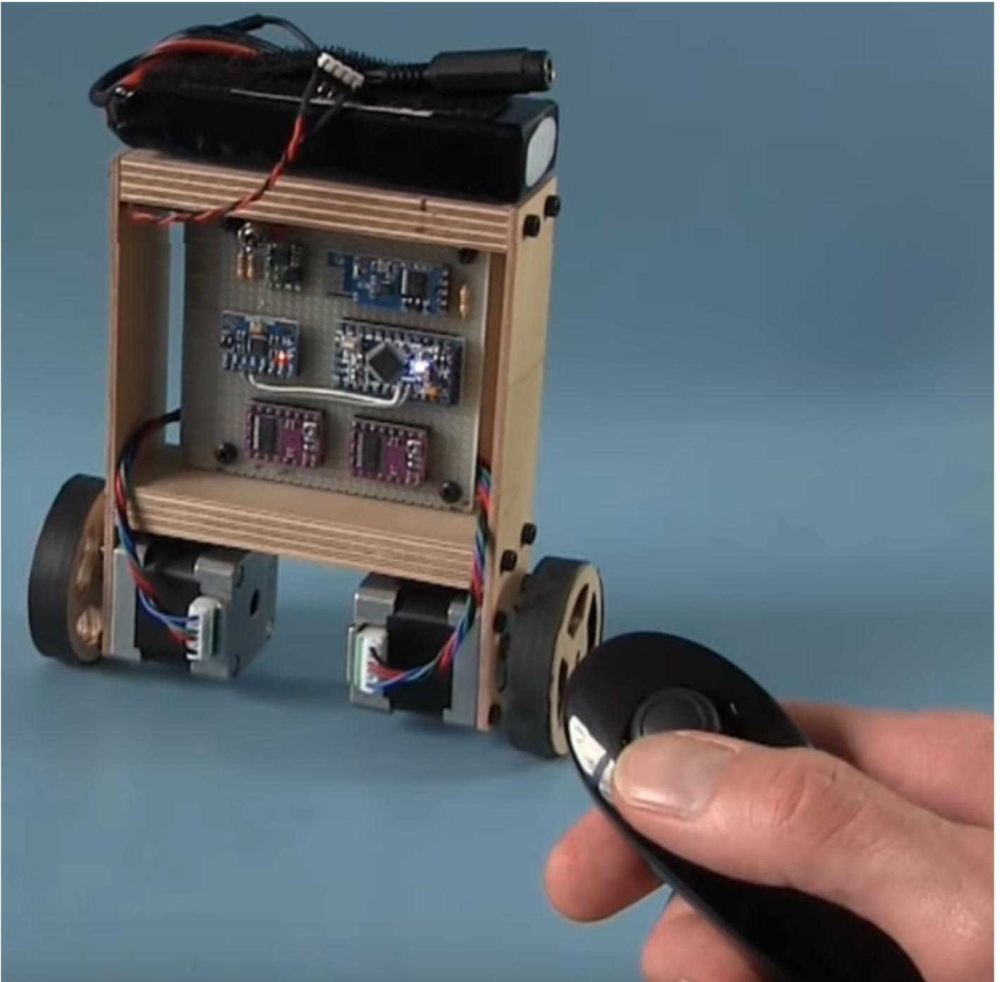
Pour ce robot, nous utiliserons le langage C++ (Arduino) pour le faire fonctionner ainsi que l'utilisation du logiciel Fusion360.
