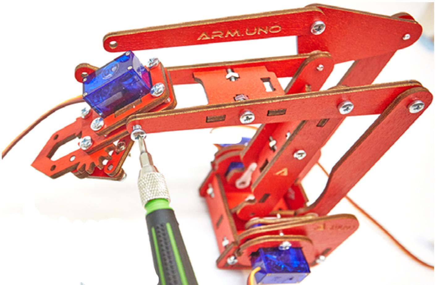
Fixer la pince au lien supérieur gauche du bras avec une vis de 3 mm x 10 mm. ne pas trop serrer, car les vis pourraient comprimer le boîtier du moteur servo, ce qui entraînerait le blocage du train d'engrenages.
