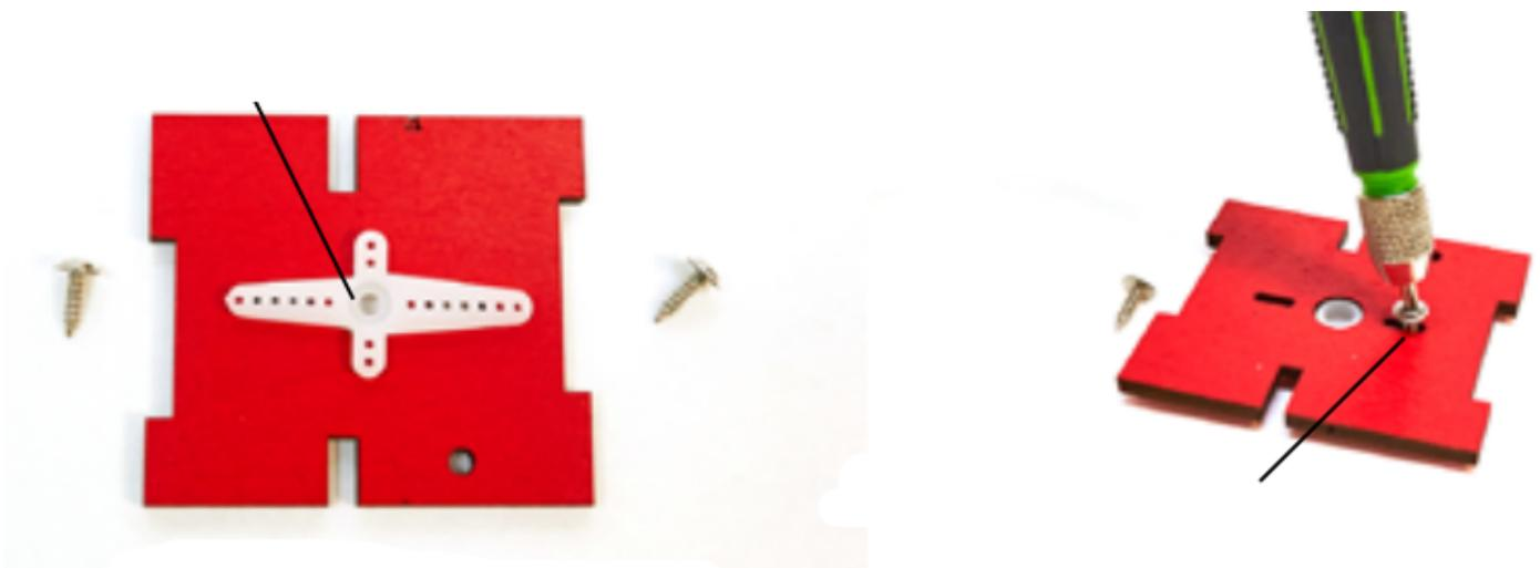
Fixez d'abord un palonnier double face à l'aide des petites vis fournies avec les servomoteurs. Faites attention à l'orientation des pièces. Notez la petite flèche gravée sur la pièce, qui pointe vers l'avant du bras. Positionnez le palonnier comme indiqué, puis retournez les deux pièces et fixez les deux petites vis.
